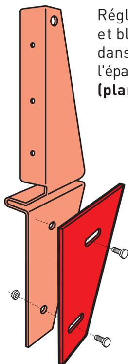
Réglage par simple coulissement et blocage de la pièce optionnelle dans les lumières, en fonction de l'épaisseur de la planche de coffrage (planches jusqu'à 65 mm maxi).
